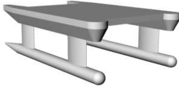
Şekil 1. Begovic ve diğ. (2015) tarafından hazırlanan SWATH modeli
