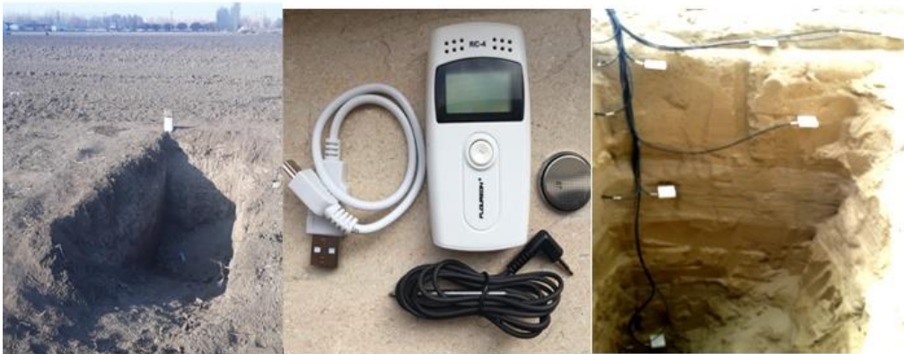
Şekil 3. Toprak profilinde Elitech RC-4 Mini TDL sensörlerinin yerleştirilmesi
