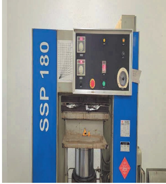
Resim 3. Levha taslağının sıcak prese yerleştirilmesi ve sıcak presleme.
