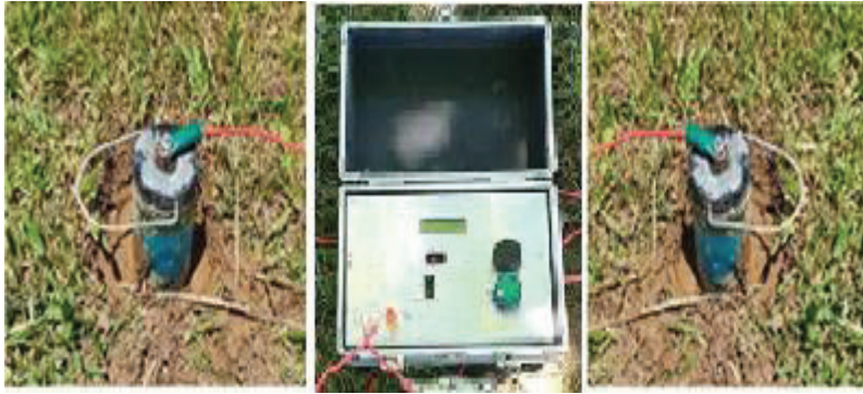
Şekil.1. Doğal Polansiyel (S.P.) Ölçüm Ekipmanı.
