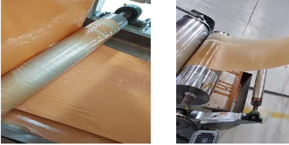
Resim 2. Cam elyafın kompozit levha üretim öncesi emprenye edilmesi
