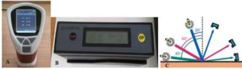
Şekil 1. Renk ölçüm cihazı (A), parlaklık ölçüm cihazı (B) ve parlaklık açıları (C) (Streitberger ve Dössel, 2008)
