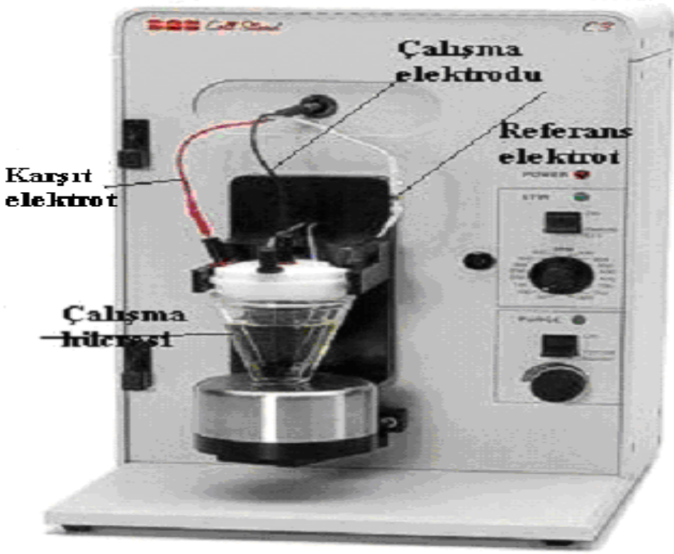
Şekil 2. Kaplama ve ölçme yapmada kullanılan hücre sistemi
