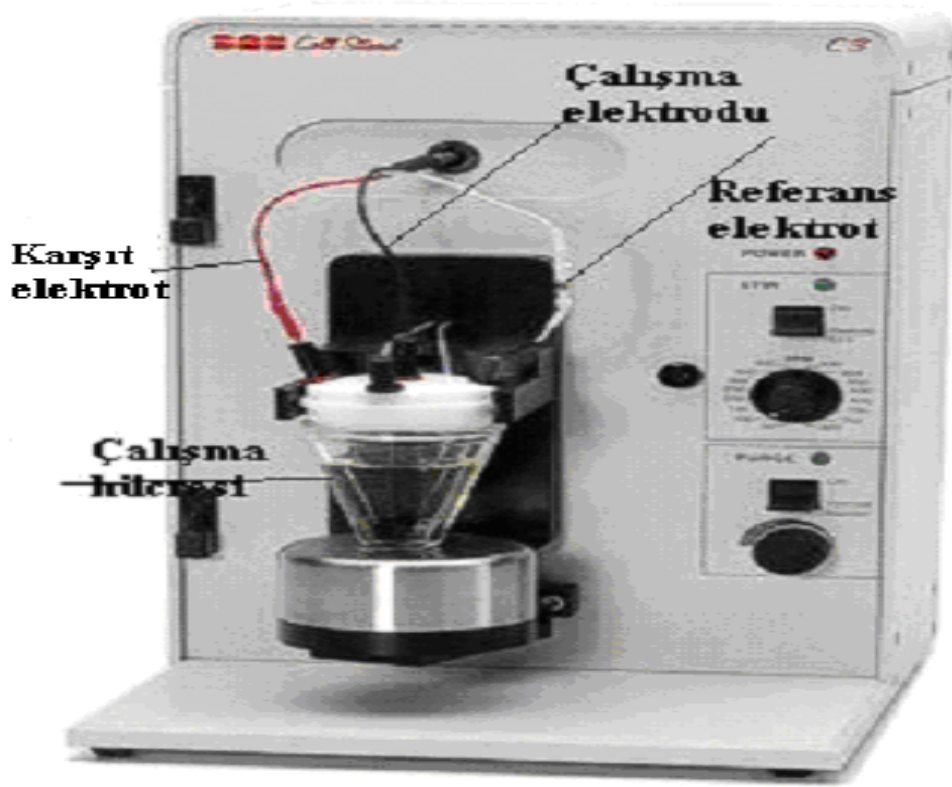
Şekil 2. Kaplama ve ölçme yapmada kullanılan hücre sistemi
