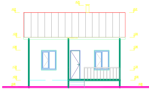
Şekil 18.Çankırı Kızılırmak Karadibek Köyü 45 Baş Yarı Açık Besi İşletmesi Projesi İdari Bina Ön Cephe Görünüşü (Kaynak: Çağırkan, 2016)
